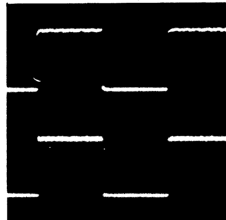
0.2ms / div, 2V / div 그림 13. 송신, 수신(상) 데이터(Ch=2). Fig 13. Transmitting, receiving data.
