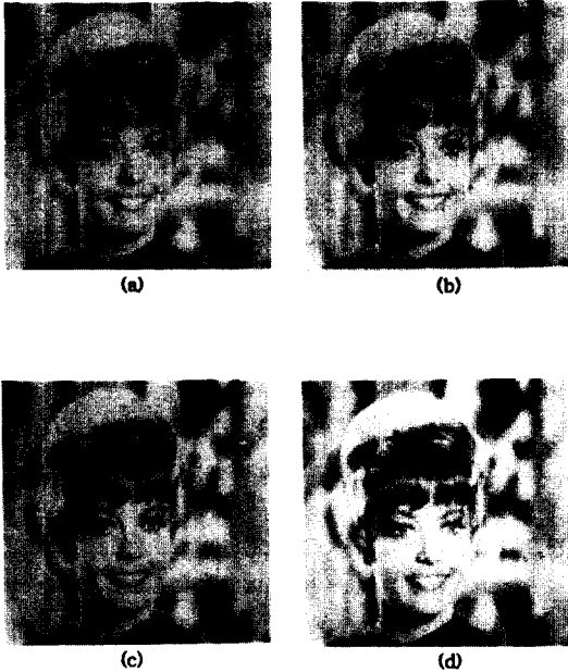
그림 6. 기존의 VQ와 2채널 VQ에 의한 재생 영상 (a) 기존의 VQ (b) 2채널 VQ (c) 기존의 LOT/VQ (d) 2채널 LOT/VQ Fig. 6. Reconstructed image by conventional VQ and 2channel VQ (a) conventional VQ (b) twochannel VQ (c) conventional LOT/VQ (d) twochannel LOT/VQ
