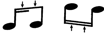
그림 13. black run length를 이용한 직선 꼬리 인식
