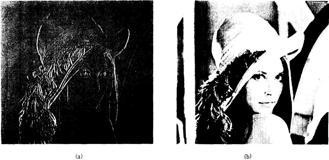
그림 10. 가변 어퍼처(aperture) 보정부(VAC)의 출력 영상 (a) PREEMPHASIS(PRE=high 모드):ON, CHROMA TRAP(BYPS=low 모드):ON, VAC(VAC1(BYPS=low 모드):ON, VAC2는 BPF(1:0)=(high, high) 모드) (b) PREEMPHASIS(PRE=high 모드):ON, CHROMA TRAP(BYPS=high 모드):ON, VAC(VAC1(BYPS=low 모드), VAC2는 BPF(1:0)=(high, high) 모드)
