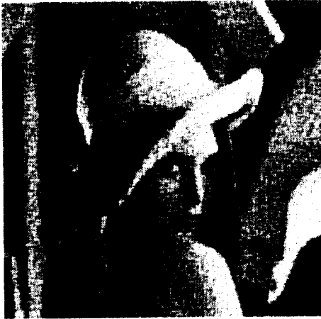
그림 4. \lambda = 0.01 을 사용하여 비적응적 방식으로 복원한 영상 Fig. 4 Restored image by using non-adaptive restoration method with \lambda = 0.01
