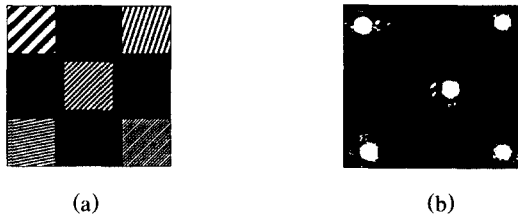
그림 12. SLM에 디스플레이된 격자 배열과 출력평면에서의 연결 결과 (a)스위칭을 위한 격자배열 (b)실험결과(출력포트 1, 3, 13, 21, 25)
