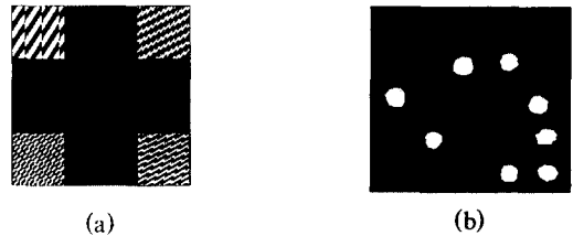
그림 13. 빔 분리와 라우팅을 위한 실험결과 (a)입력빔을 두 개로 분리하는 격자배열 (b)출력포트 1, 2, 6, 9, 11, 15, 17, 18
