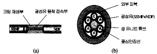
그림 4. 분산 분포 케이블 구조 (a) 접속부 (b) 케이블 구조
