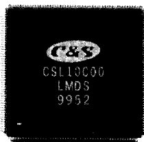
그림 12. 제안된 LMDS downstream 수신기의 칩 사진
