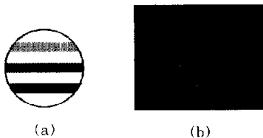
그림 10. LCD의 위상 변조 실험 결과 (a) 입력 영상 (192, 128, 0 레벨), (b) 그림 7(a)에 의한 간섭 패턴
