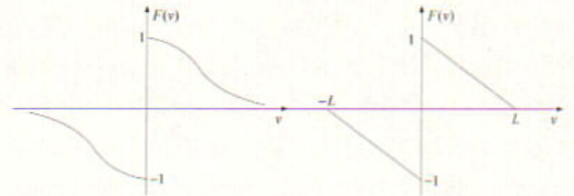
(a) SIDE F 함수 특성 (b) 본 논문에서 사용한 F 함수 그림 4. SIDE F 함수 특성 및 본 논문에서 사용한 F 함수
