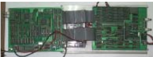
그림 4-1. 제작된 프랙탈 영상 복호화기의 사진 Fig 4-1. Photograph of the constructed fractal image decoder.
