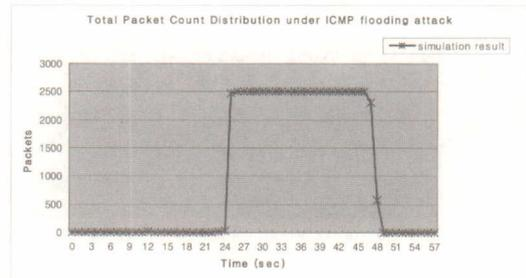
그림 8. 시뮬레이션 환경에서의 DDoS 공격 결과 (간격 0.0004초)
