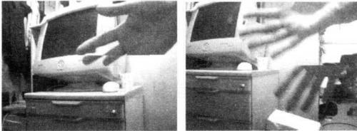
그림 5-a. 기존 디스플레이 구조를 갖는 DVR 에서의 tearing 현상
