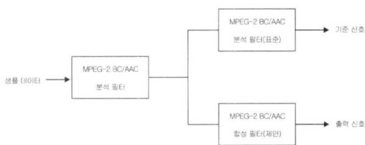
그림 8. 제안 구조 검증 시뮬레이션 블록도
