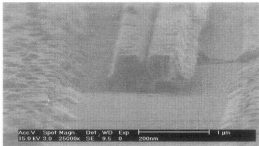
그림 6. 제작된 0.2 μm T-게이트의 SEM 사진
