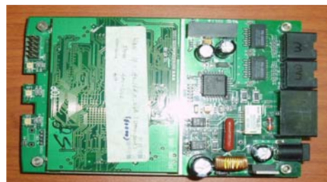
그림 5. VPN을 적용한 VoIP단말기 하드웨어의 모습
