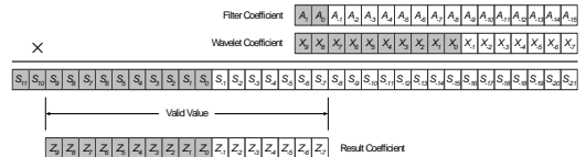
그림 2. 필터 연산을 위한 고정소수점 곱셈연산 Fig 2. Fixed-point multiplication for filter operation
