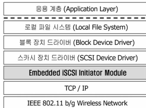
그림 3. 모바일 장치상의 시스템 계층 구조
