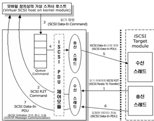
그림 4. iSCSI Read 동작 과정
