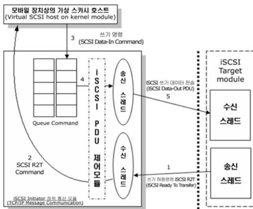
그림 5. iSCSI Write 동작 과정
