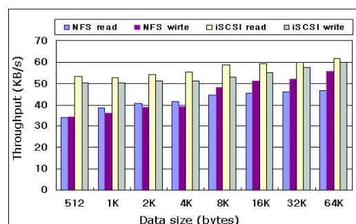
그림 10. 입출력 처리량 측정 결과 (NFS vs iSCSI)
