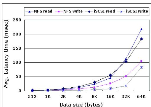
그림 9. 입출력 지연율 측정 결과 (NFS vs iSCSI)
