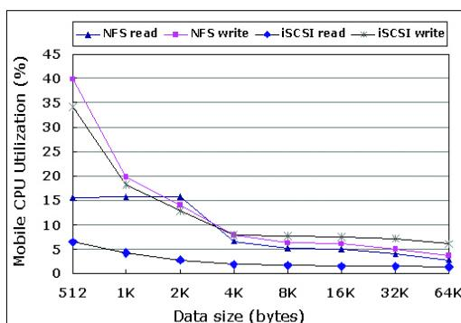
그림 8. CPU 점유율 측정 결과 (NFS vs iSCSI)
