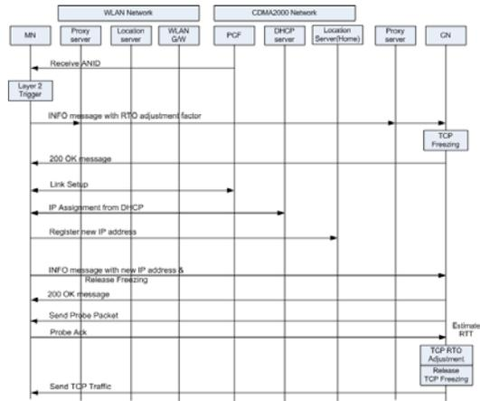
그림 3. Probe Packet을 이용한 방법의 메시지 흐름도
