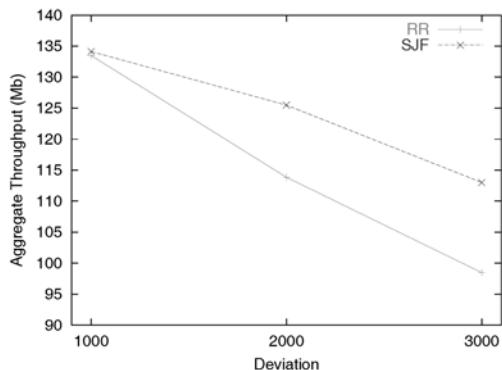
그림 11. 채널 스케줄러에 따른 aggregate throughput
