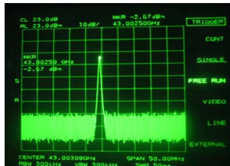
그림 15. 국부발진용 건발진기 특성 Fig. 15. Spectrum of Gunn oscillator for Local Oscillator.
