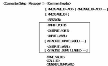
(a) parallel 방식의 제안한 ConnectionSetup 메시지의 형식 (AC-노드)
