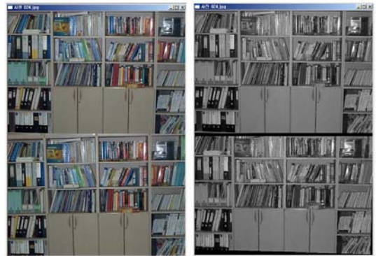
그림 17. 원 영상(좌) 과 기울어짐이 제거된 영상(우) Fig. 17. Original Image(Left) and Removed Geometry Distortion Image(Right)
