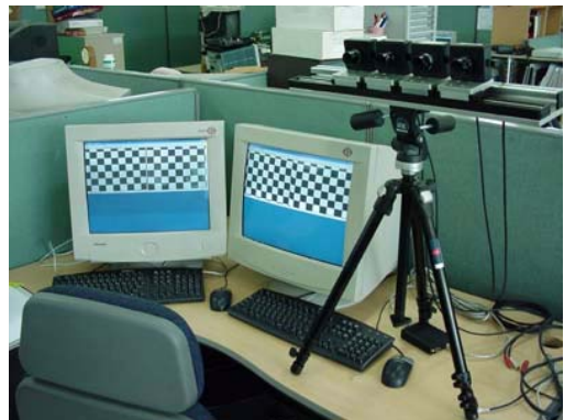
그림 7. 다시점 보정처리 시스템 Fig. 7. Multiview Calibration System
