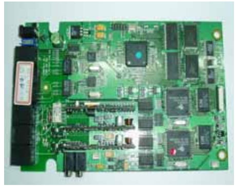
그림 5. 분산형 IP PBX 단말기 하드웨어
