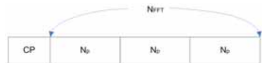
그림 1. 시간영역에서의 프리앰블의 구조 Fig. 1. Preamble structure in time domain
