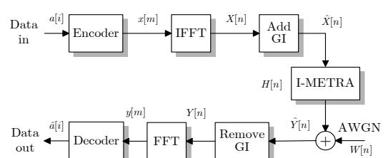
그림 3. OFDM 시스템 구조
