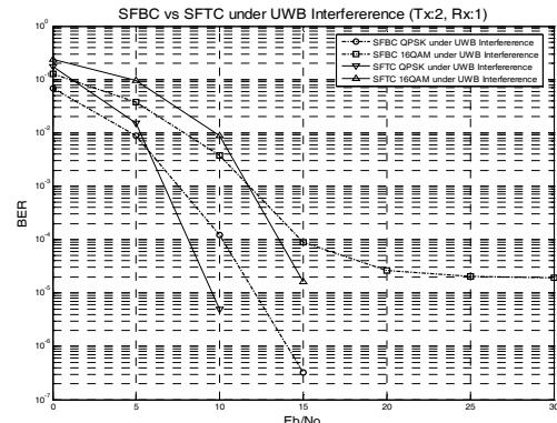
(a) MB-OFDM UWB Interferer가 있는 환경에서의 SFBC-OFDM(Tx:2, Rx:1)과 SFTC-OFDM(Tx:2, Rx:1) 성능
