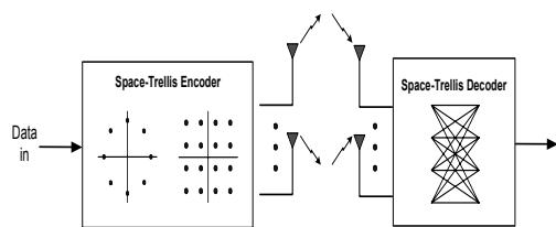
그림 2. SFTC-OFDM 방식의 블록도
