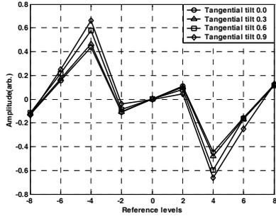
그림 4. PR(12221)ML 검출기에서 이상적인 가지값과 디스크 기울임 각도에 따른 가지값의 변화에 대한 분석 그래프
