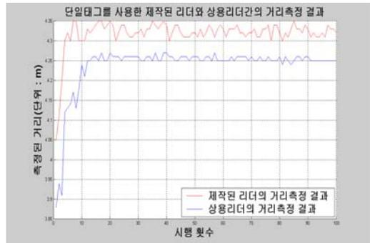
그림 15. 단일태그를 사용한 제작된 리더와 상용리더간의 거리측정 결과
