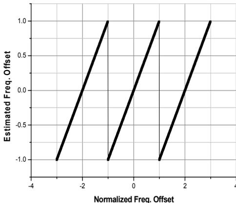
그림 10. 신호의 반복 특성을 이용한 알고리즘의 주파수 옵셋 검출 특성
