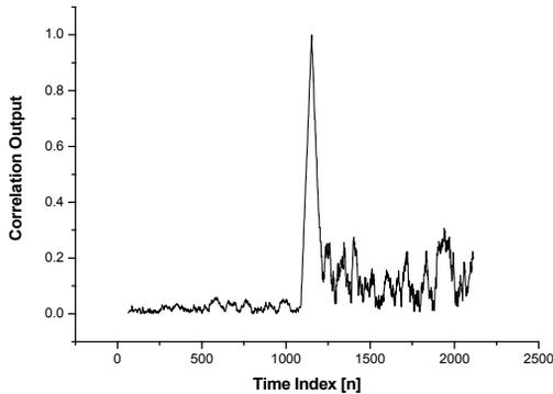
그림 7. CP를 이용한 알고리즘의 상관 출력 특성
