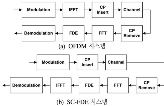
그림 1. OFDM과 SC-FDE 시스템의 블록 다이어그램
