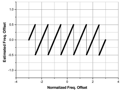
그림 8. CP를 이용한 알고리즘의 주파수 오프셋 검출 특성
