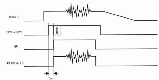
그림 6. Power ON/OFF Sequence 오실로스코프 결과
