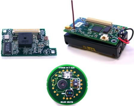
그림 3. MICA2/MICA2DOT/Sensor board
