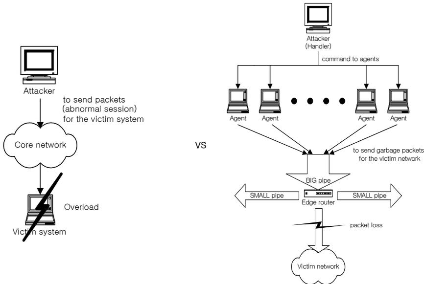
그림 1. 시스템 기반 및 네트워크 기반 서비스 공격
