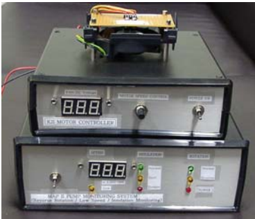
그림 11. 수중펌프 모니터링 테스트베드
