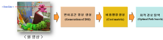
그림 1. 다이나믹 프로그래밍 기반의 변이 추정 Fig. 1. Disparity estimation by dynamic programming
