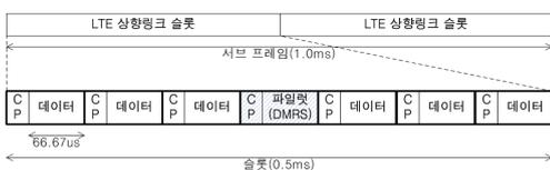
그림 8. LTE 상향링크의 데이터 및 파일럿 구성
