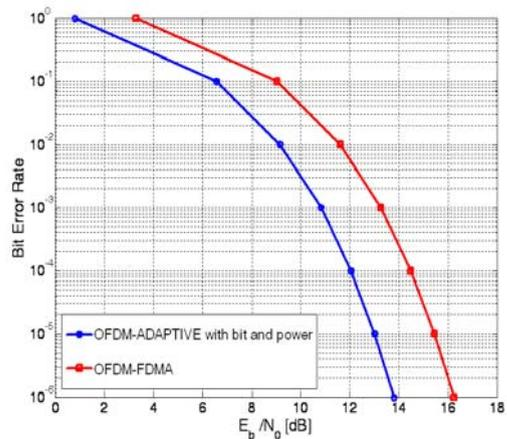
그림 2. 적응적 방식과 고정된 부채널 개수와 비트수를 사용하는 경우 (OFDM-FDMA)에 대하여 비트 오율에 따른 평균 비트에너지대 잡음비 ( $E_b/N_0$ )
