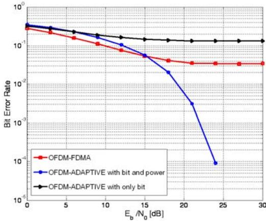
그림 3. 2명의사용자에 대하여 부채널, 비트, 전력 할당을 사용하는 적응적 전송방식과 고정된 OFDM-FDMA 및 비트 할당만 사용한 시스템의 비트 오류 성능
