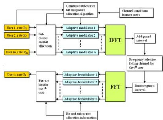
그림 1. 부채널, 비트, 전력 할당을 사용하는 다중 사용자 OFDM 시스템의 블록도
