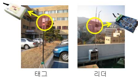
그림 16. 리더와 태그의 설치
