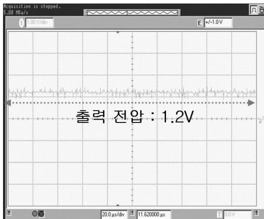
그림 7. 100mA 부하에서의 출력 전압과 리플 파형 Fig. 7. Output voltage & ripple in 100mA load
