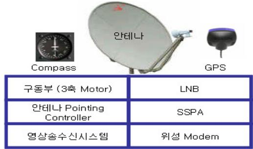
그림 2. 자동안테나 시스템 구성도
