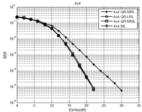
그림 2. 4x4 송수신 환경에서의 모의실험
