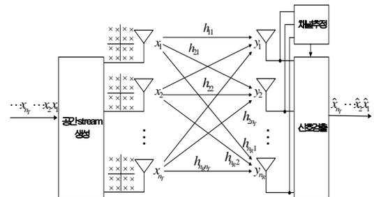
그림 1. 공간다중화 MIMO 시스템 모델
