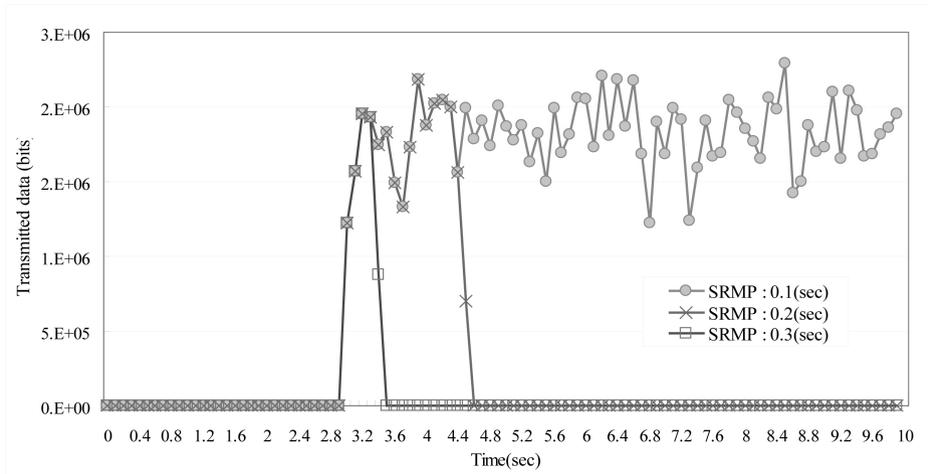
그림 11. SR에서의 공격 트래픽 전송량 ( $T_{h,f} = 0.76\text{Mbits}$ )
