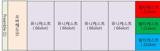
그림 1-(c). FFR을 사용하는 기지국의 하향링크 프레임
