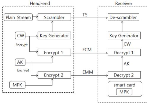
그림 1. 수신제한시스템 (CAS: Conditional Access System)
