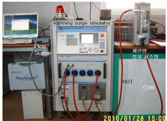
그림 5. 제안한 접지시스템의 측정 구성도
