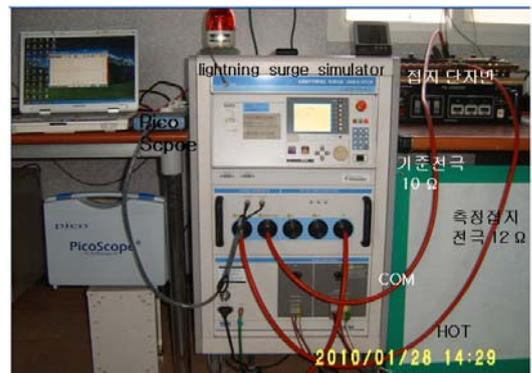
그림 2. 기존 접지시스템의 측정 구성도
