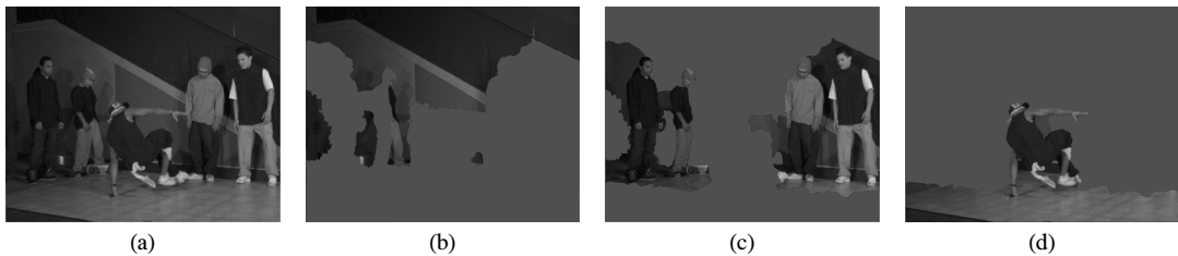
그림 6. 가우시안 혼합 모델에 상응하는 EM 군집 기법의 결과 영상 (시퀀스 “Breakdancers” 1번 시점, 1번 영상) (a) 원본 영상, (b) 1번 깊이 레벨에 따라 분리된 영상, (c) 2번 깊이 레벨에 따라 분리된 영상, (d) 3번 깊이 레벨에 따라 분리된 영상 Fig. 6. The result image applied to Expectation Maximization clustering based on Gaussian Mixture Model (Sequence “Breakdancers” view 1, frame 1) (a) Original image, (b) Classified image according to depth level 2, (d) Classified image according to depth level 3
