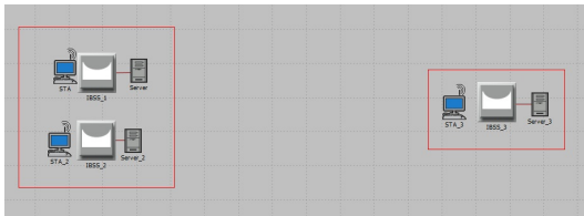
그림 1. 간섭을 미치는 BSS와 간섭이 없는 BSS (IEEE802.11b, 전송 파워 : 1mw, Traffic Type : CBR. 거리 : 1km, Data Rate : 11Mbps)
