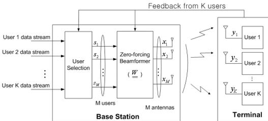
그림 1. 사용자 선택 기법이 적용된 다중 사용자 MIMO 시스템
