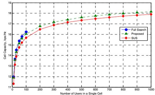
그림 3. User수 Scale을 확장했을 경우 셀 용량 비교 (M=4 and transmit SNR=10dB)
