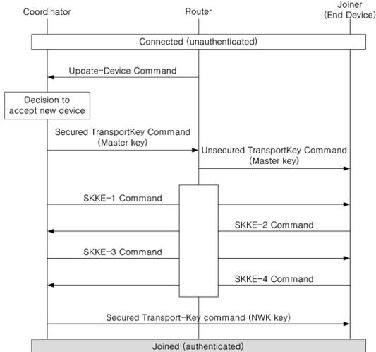
그림 3. ZigBee 네트워크에서의 키 설정 과정
