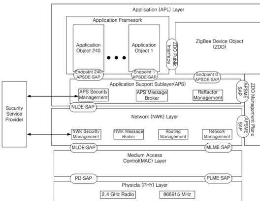
그림 2. ZigBee 스택 구조
