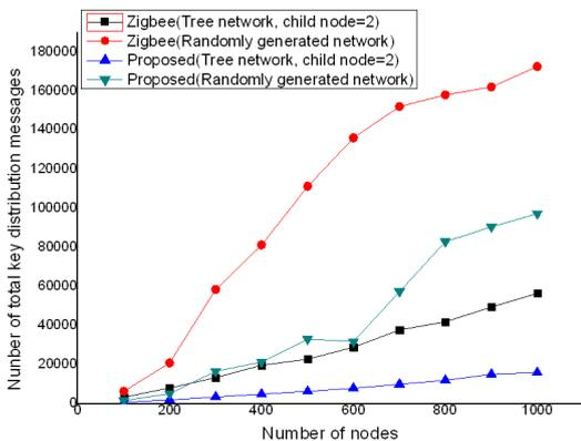
그림 9. 제안한 ZigBee 프로토콜과 기존의 ZigBee 프로토콜의 키 분배 메시지 수
