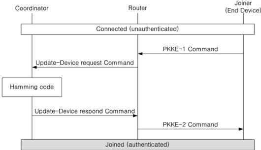
그림 4. SmartGrid ZigBee 네트워크에서 제안한 키 설정 과정
