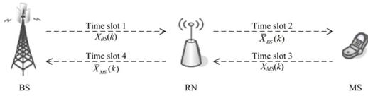
그림 1. 일반적인 TDD 스케줄링 기법을 적용한 송·수신 과정
