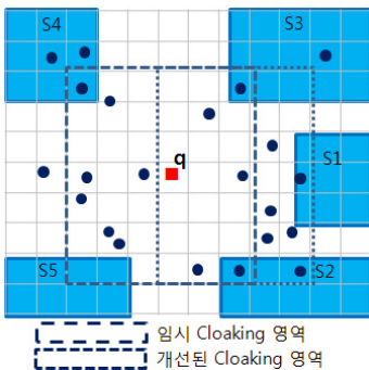
그림 5. 건물위치에 따른 잘못된 Cloaking 영역 설계
